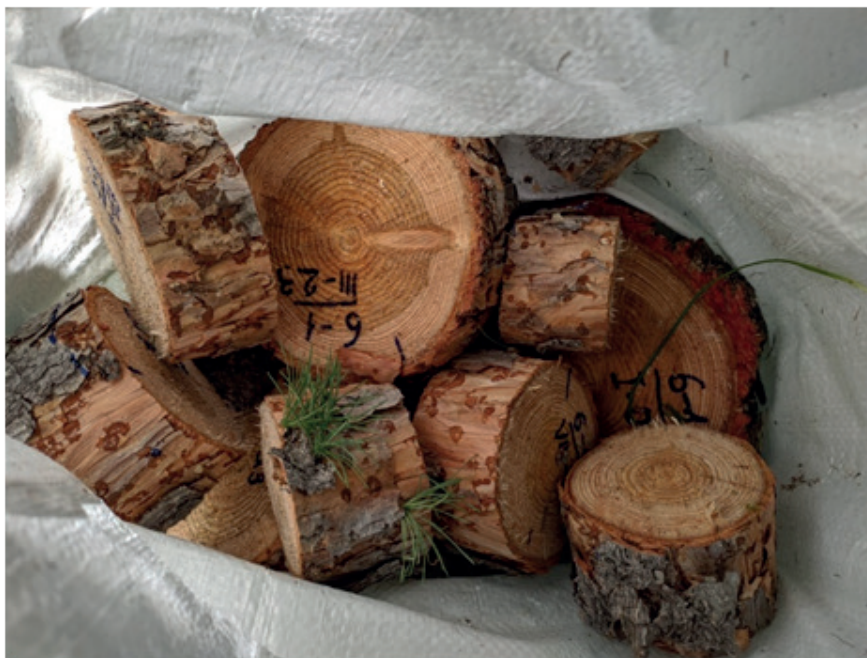
Рисунок 1 – Промаркированные образцы спилов взятые с модельного дерева
