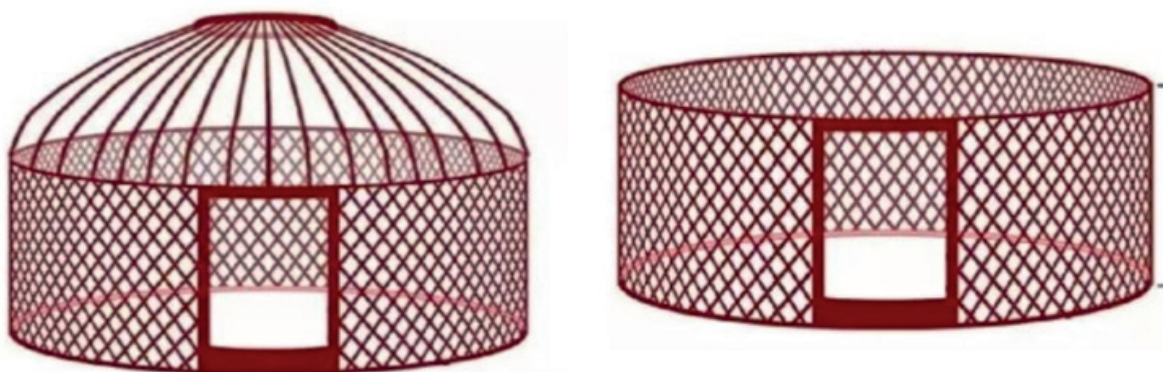
Сурет 4 - Киізүйдің геометриялық формалары
