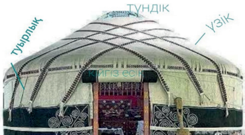
Сурет 6 - Киіз үйдің сыртқы құрылымының атаулары
