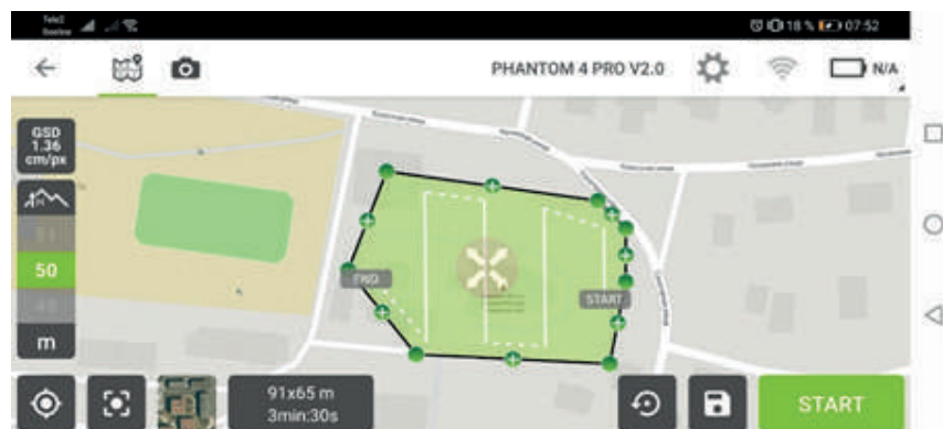
Рисунок 1- Схема многомаршрутной съёмки архитектурного объекта
