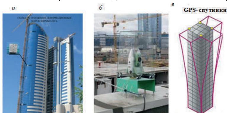
Рисунок 2 - Расположение контрольных марок на объекте (а); мониторинг здания с применением роботизированного электронного тахеометра (б); общая схема GPS-мониторинг ветрового воздействия на высотное здание (в)
