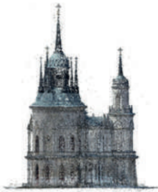
Рисунок 2 - Изображение, построенное из разреженного облака точек
