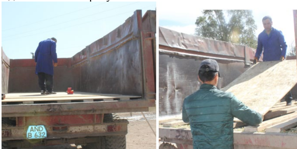
Рисунок 5.1 – Основание кузова тракторного прицепа в момент покрытия древесными листами
