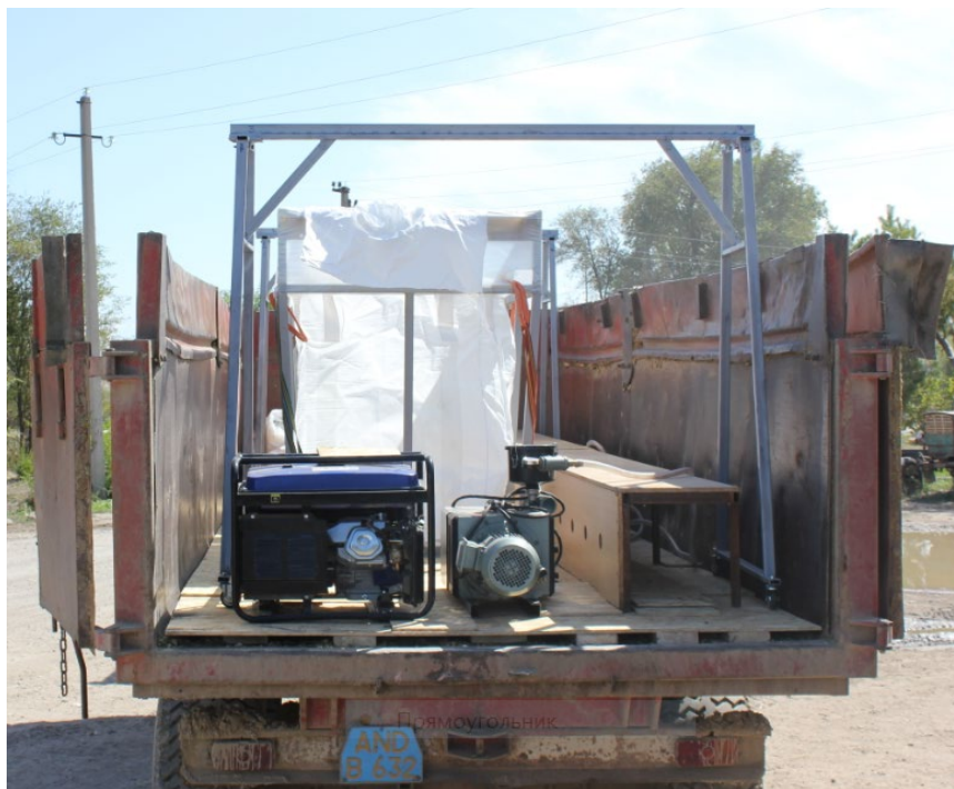
Рисунок 5.4 – Общий вид размещения средств для вакуумирования в кузове тракторного прицепа
