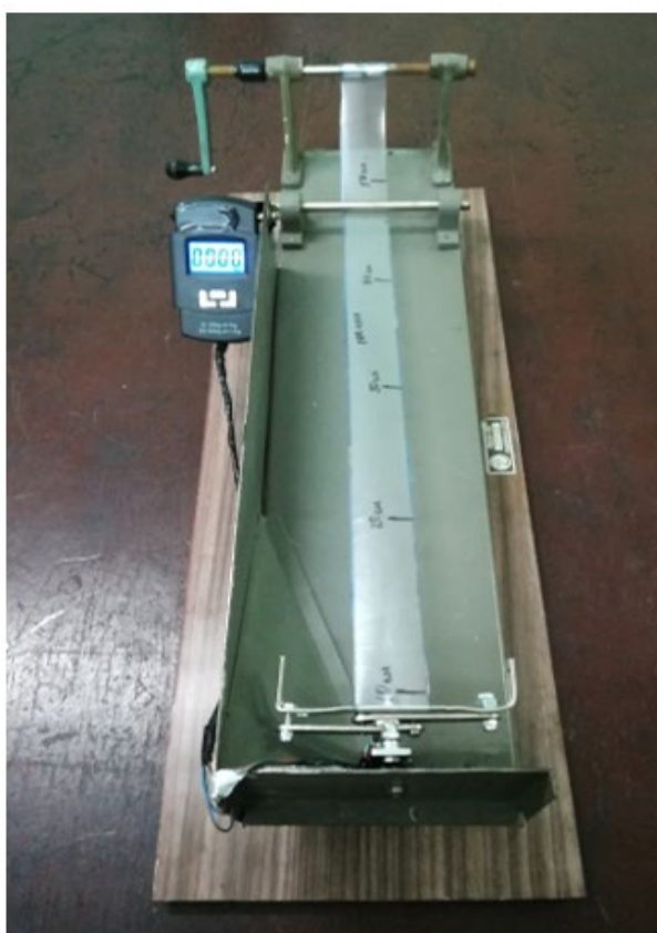
1 – рукоятка; 2 – опора; 3 – мерная шкала; 3 – подвижная часть; 4 – образец растяжения; 5 – тензодатчик
