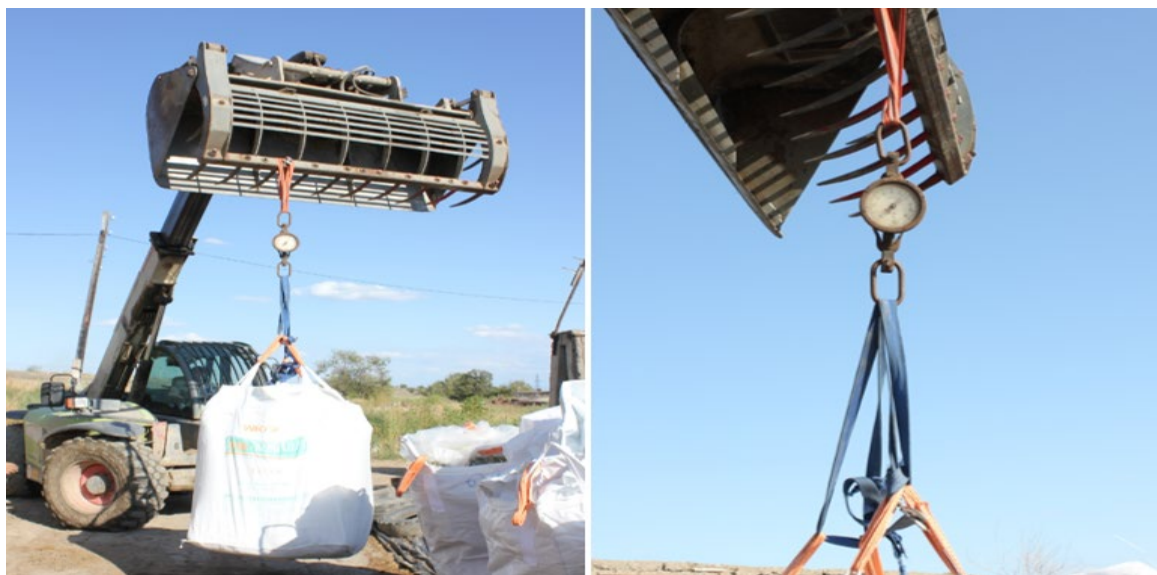
Рисунок 5.8 – Определение массы мягкого контейнера с уплотненным силосом
