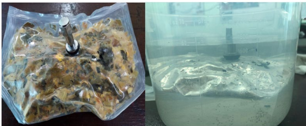
Рисунок 3.2 – Закладка силосной массы в мягкий мини контейнер (а) и размещение мини контейнера с силосной массой в емкость с водой (б)
