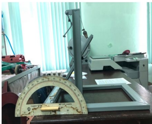
1 – поверхность трения; 2 – станина; 3 – кронштейн; 4 – барабан лебедки; 5 – опорный ролик; 6 – сектор замера угла; 7 – натяжной трос
