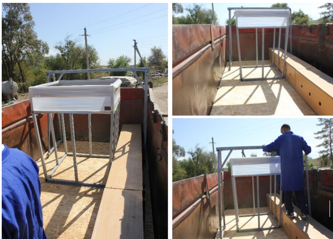
Рисунок 5.2 – Размещение ступеньки и матрицы на основании кузова
