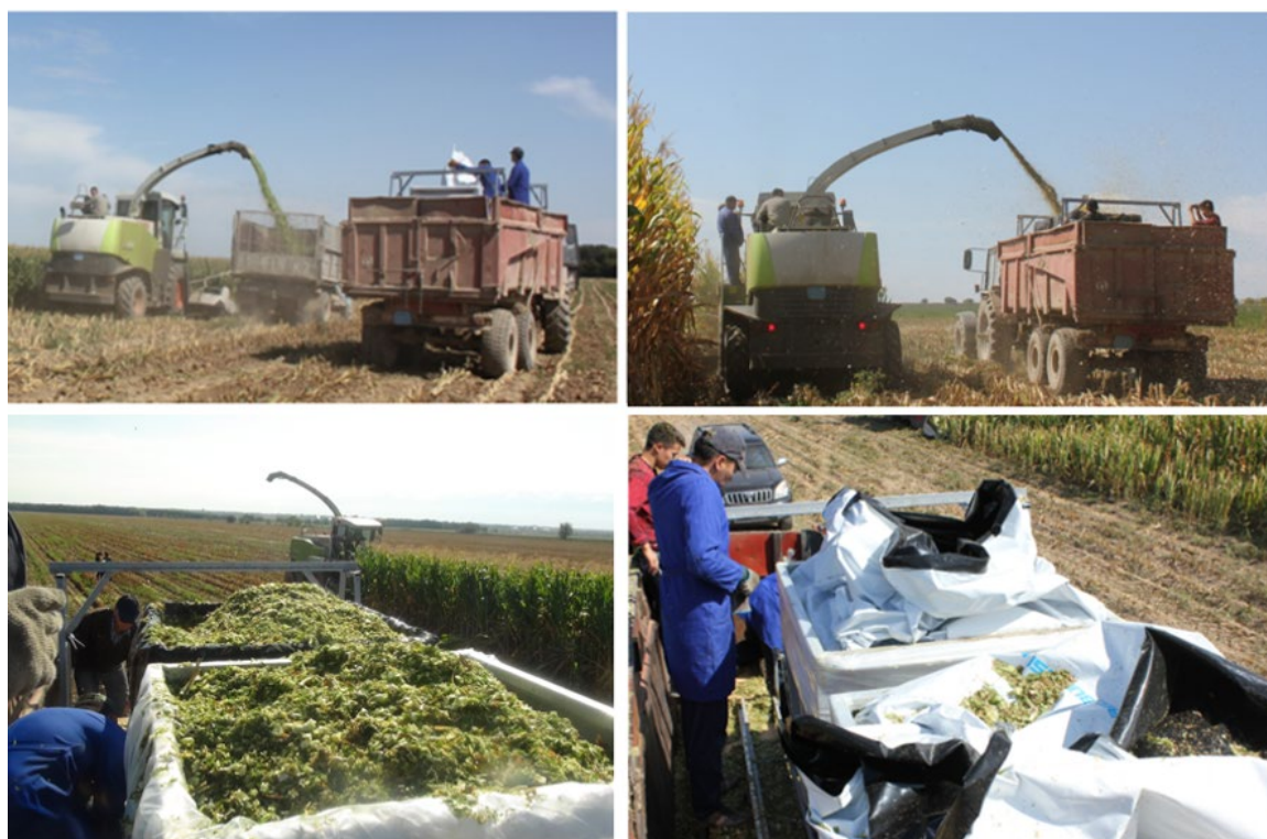
Рисунок 5.5 – Момент загрузки измельченной силосной массой мягкие контейнеры, размещенные в кузове тракторного агрегата комбайном
