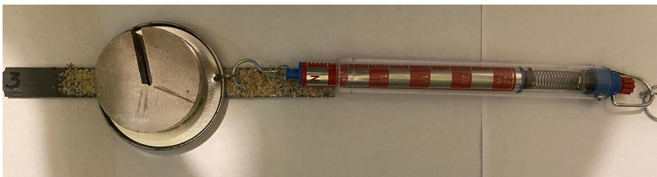
Рисунок 3.5 – Измерение силы трения
