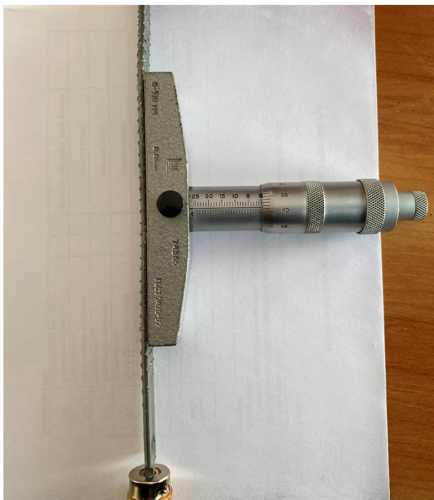
Рисунок 3.3 – Измерение высоты насечек рабочей поверхности с помощью микрометрического глубиномера
