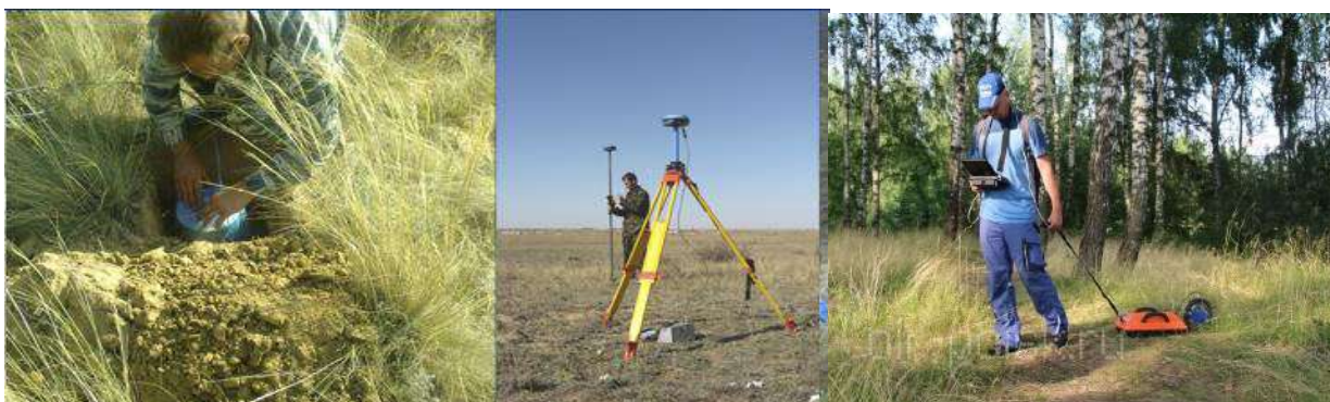
Сурет 4.1 - Радиолокация және сейсмикалық әдістермен геофизикалық жұмыстарды орындау
